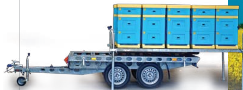
P2 Прицеп платформа 2×ось, 1300 кг, с тормозом, 2600×1620 мм
