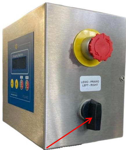
Фото 22 Переключатель „ПРАВО/ЛЕВО” расположен на блоке управления
