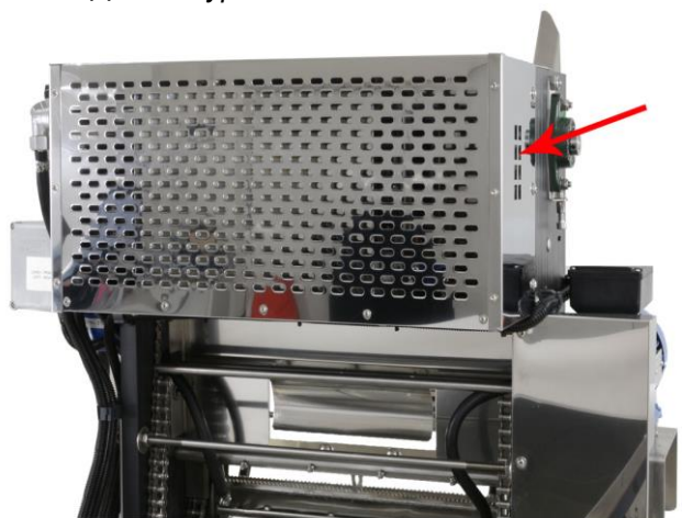
Фото 17 За корпусом находится датчик уровня жидкости. Уровень жидкости необходимо контролировать, чтобы не допустить повреждения нагревателей.
