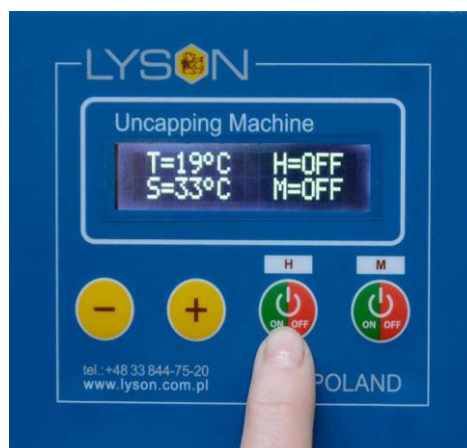
Фото 8 После выключения нагревателей на блоке управления появится коммуникат „OFF” и графический символ с левой стороны исчезнет.
