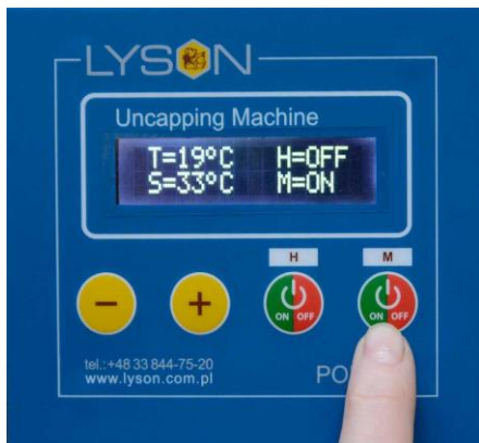
Фото 9 Включение ножей кнопкой №4 „ON/OFF”. После включения ножей на дисплее появится коммуникат «ON» и ножи станка начнут движение
