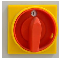
Фото 19. Выключатель – позиция „0” Только в таком случае разрешается осуществлять необходимые поправки в настройках станка
