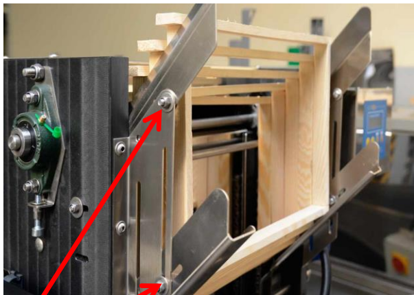
Фото 11 Регуляция верхней и нижней направляющих и правильное расположение рамок в них
