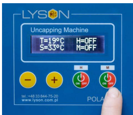
Фото 10 Выключение ножей кнопкой №4 „ON/OFF”.
