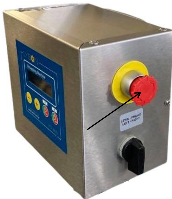
Фото 20. Аварийная кнопка СТОП
