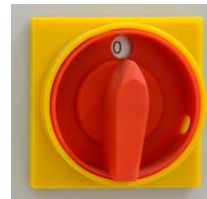
Фото 20 Выключатель „0/1” станки с питанием 230В или позиция „ЛЕВО/0/ПРАВО” станки с питанием 400В
