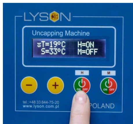
Фото 7 После включения нагревателей на дисплее высветится коммуникат „ON”, с левой стороны появится графический символ Фото 7
